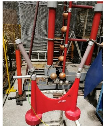
Fig. 8 – Eclatorul de măsură utilizat pentru măsurarea tensiunilor de impuls generate de GIT 160 kV
